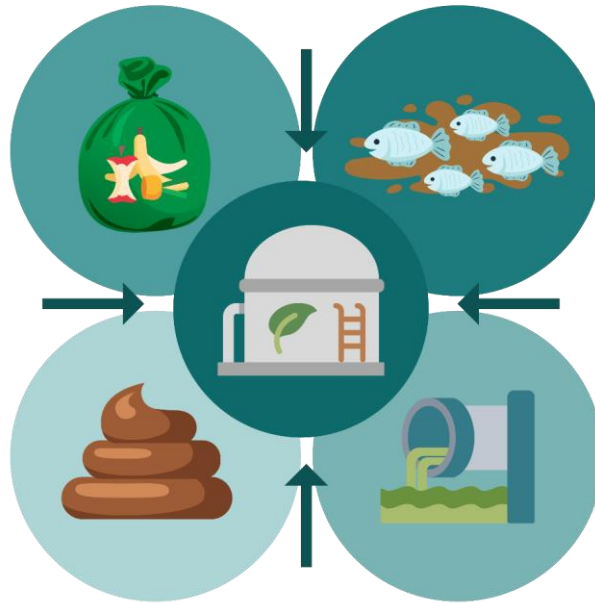
Biojätteen lähteet, jotka voidaan pilkkoa anaerobisesti biokaasun ja biolannoitteen tuottamiseksi.
